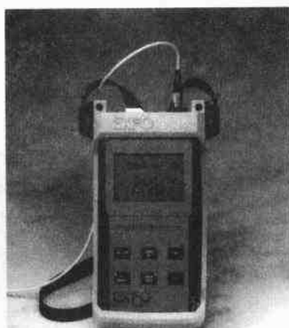
图 13.2 通用手持式光功率计样品 (EXFO.E.O Inc.工程部授权提供的 FOT-90A 模型)
