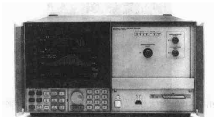
图 13.5 通用光谱分析仪 (OSA) 及其屏幕上显示的典型测量轨迹 (Hewlett-Packard Co.授权提供的 HP-70951A 型)
